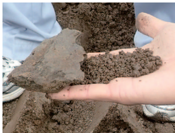
写真4 改良前(左)と改良後(右)の外観
